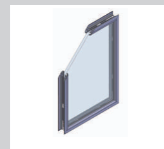
Oblò "HV" con profilo perimetrale in alluminio verniciato nero, a spigoli vivi, con vetro stratificato fino a 19 mm. "HV" windows, rectangular shape, sharp corners, EPDM black rim with anti-injury glass Visarm up to 19 mm thickness.
